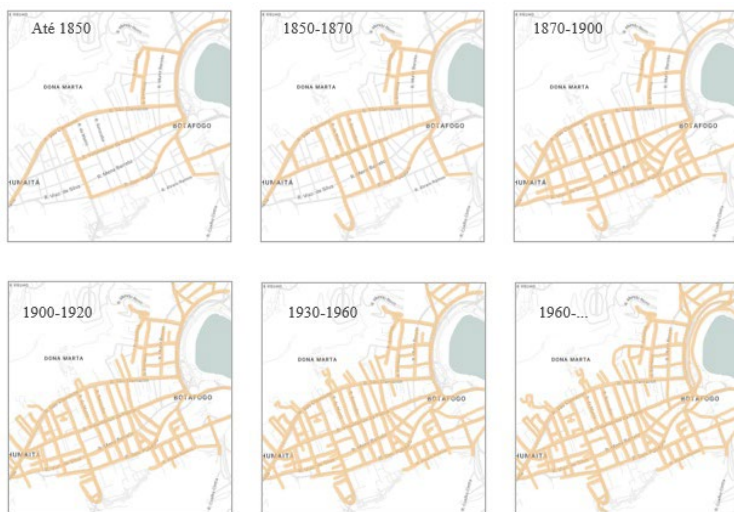
Figura 1: Abertura de vias no bairro de Botafogo, Rio de Janeiro – RJ
